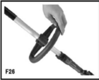
Installez la vis de maintien du bail, passez la au travers du trou (F26\F27)
