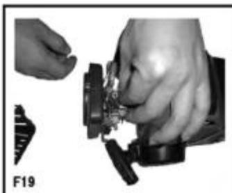
Le macrospore de la fente supérieure du crochet vise la poignée du fil en acier et la poignée du fil en acier vise la fente, et serrez le tout (F19\F20)
