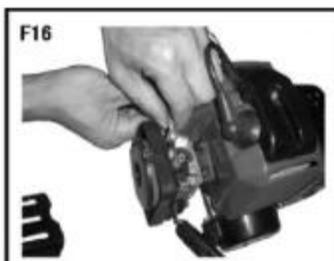
Ajustez la vis dans le trou fileté du crochet acier du carburateur (F16)
